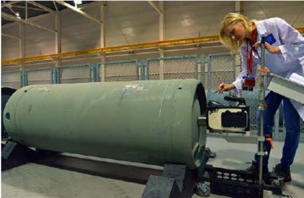
Messung von Uranhexafluorid durch eine Safeguardsinspektorin – URENCO
